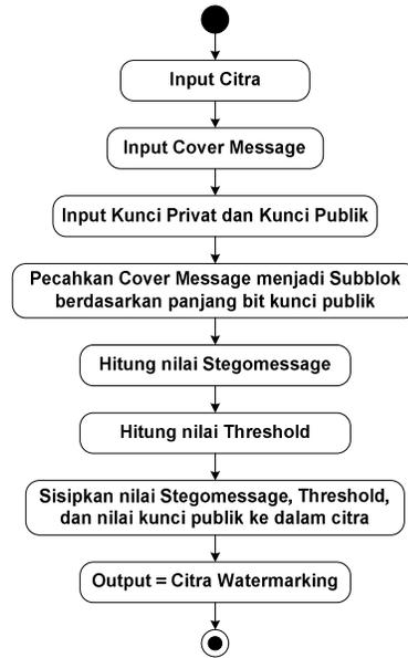
Gambar 3. Proses pembuatan *watermarking*
